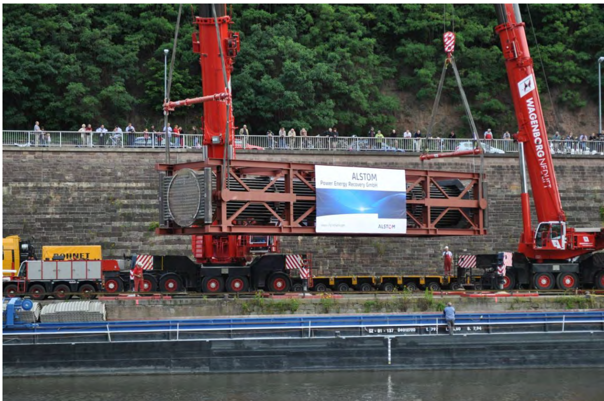
Foto: Verladung eines Synthesegaskühlers in HannMünden auf ein Wesertransportschiff am 07. August 2012
