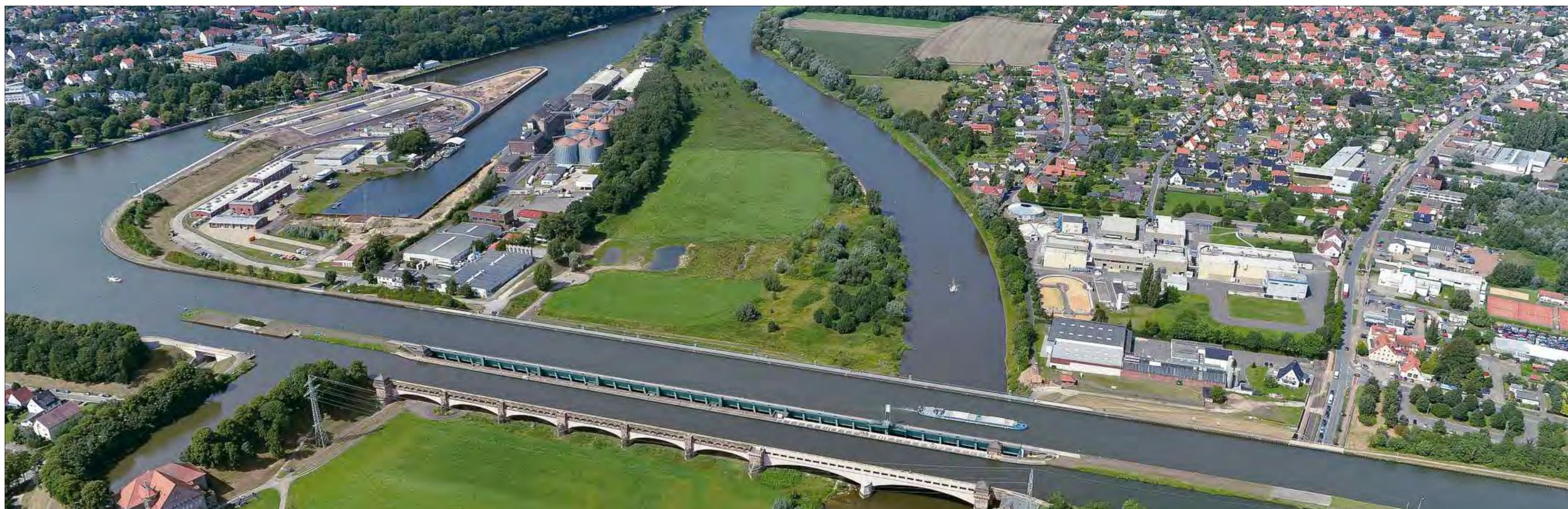
Drehkreuz der Schifffahrt: 1915 wurden die Kanalüberführung über die Weser und die Schachtschleuse und damit der Weser-Ems-Kanal als westlicher Arm des Mittellandkanals eröffnet. 1998 wurde die neue Kanalbrücke eröffnet. Jüngst folgte die neue 139 Meter lange Weserschleuse, die die Mittelweser für Großgütermotorschiffe öffnet.
